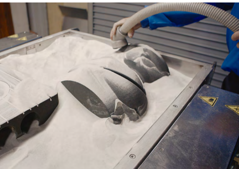
Abb. 2 Fertigung neuer Bauteile mithilfe einer 3-D-gedruckten Sandform.
