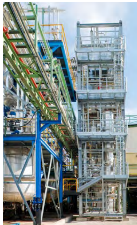
Abb. 1 Vormontierte modulare Anlage zur Reinigung von Ethoxyquin.
