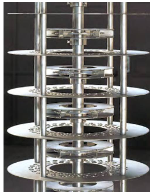
Abb. 3 Die Einbauten der gerührten Kühni-Kolonne werden auf Kundenbedürfnisse zugeschnitten.
