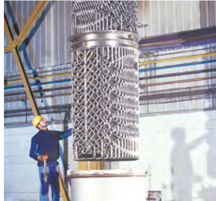
Abb. 6 Wärmeübertragung und Mischen in einer Stufe mit dem Mischreaktor SMR™.
