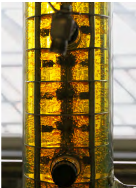
Abb. 2 DAE-Tröpfchenverteilung in der gerührten Kühni-Kolonne (ECR).
