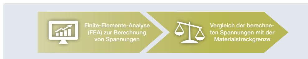
Abb. 5 Konstruktive Analyse der Schaufeln.
