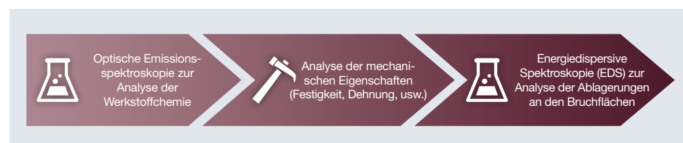
Abb. 3 Materialanalyse der beschädigten Bauteile.
